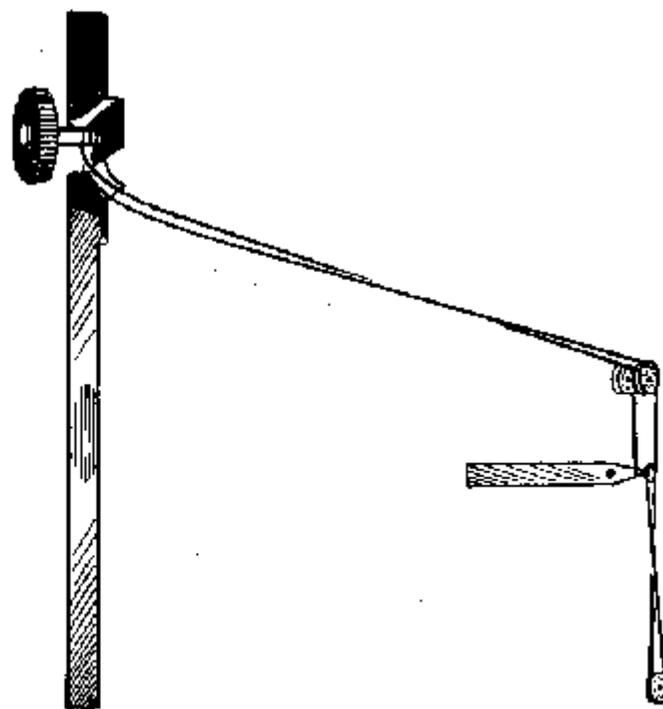
*Montaggio della funicella del ricevitore PERCUSATI mod. E/505. La prima funicella compie tre giri attorno al perno di comando di sintonia.*
