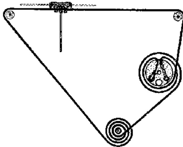
*Meccanica della scala parlante dei ricevitori RADIOMARELLI modd. 159 - 161 - 162 - 163 - 169. Una delle due estremità della funicella va annodata ad asola e fissata al rotore; la funicella vien fatta girare nel rotore da destra verso sinistra; vien fatta passare poi nella prima puleggia da destra verso sinistra e, successivamente, nella seconda; la funicella deve compiere due giri attorno al perno di comando prima di ritornare al rotore, cui va fissata con la molla di tensione.*
