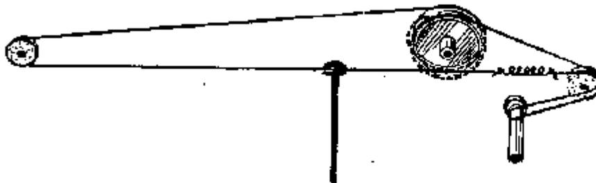
*Meccanica della scala parlante dei ricevitori SIEMENS mod. SM738 - 7138. La lunghezza complessiva della funicella è di 130 cm.*
