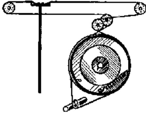
*Montaggio della funicella dei ricevitori PHONOLA modd. 724 - 5512 - 5517 - 5518. I tratti di funicella sono due: uno di acciaio e uno di seta.*
