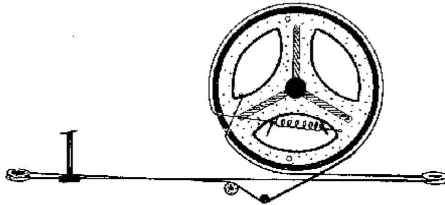
*Montaggio della funicella per lo spostamento dell'indice della scala parlante dei ricevitori a valvole SIEMENS modd. 533 - 6033. La lunghezza della funicella è di 95 cm.*
