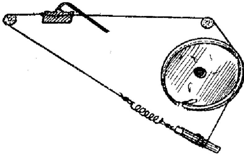
*Meccanica della scala parlante dei ricevitori a valvole PHONOLA modd. 5539 - 5541R - 5543R. La lunghezza della funicella è di 720 mm; in essa vengono praticati tre nodi ad asola: uno ad una estremità, un secondo a 215 mm. dal primo ed un terzo alla estremità opposta.*
