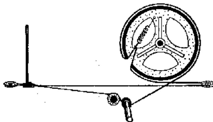
*Montaggio della funicella per lo spostamento dell'indice della scala parlante dei ricevitori a valvole SIEMENS modd. SM5123 - SM5022 - SM6133. La lunghezza della funicella è di 100 cm. per il modello SM5123 ed è di 95 cm. per il ricevitore SM5022.*
