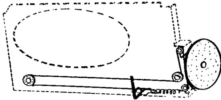
*Meccanica della scala parlante del ricevitore a valvole PHONOLA mod. 675B. La funicella deve essere di acciaio della lunghezza di 780 mm, provvista di nodo ad asola su entrambe le estremità.*
