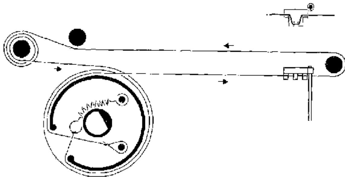
*Montaggio funicella della scala parlante del radiofonografo
