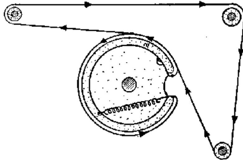
Montaggio funicella per scala parlante dei ricevitori MAGNADYNE modd. S11 - S12. La funicella compie tre giri attorno al perno del comando di sintonia.
