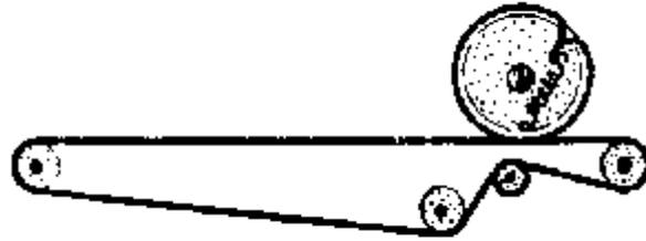
*Meccanica della scala parlante dei ricevitori Philips modd. 371A - 460A - 472A. La funicella è fissata, per mezzo di un nodo, al rotore; essa scorre poi sull'incavo della puleggia posto all'estrema destra; viene avvolta con due giri attorno al perno e fatta scorrere, quindi attraverso gli incavi delle altre due pulegge, per ritornare finalmente al rotore.*
