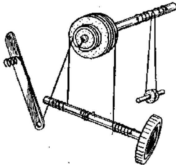
*Meccanica della scala parlante dei ricevitori **RADIOMARELLI** modd. **9 U 65** - **9 A 75** - **9 A 85** - **9 A 95**. Le funicelle, in questo particolare tipo di meccanica, sono in numero di tre: quella avvolta sul perno in alto sostiene gli equipaggi; quella avvolta all'estrema destra del perno in basso comanda il tamburo; quella all'estrema sinistra guida l'indice della scala.*
