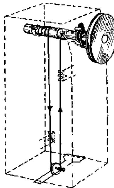
Meccanica dell'induttore variabile del ricevitore **RADIOMARELLI** mod. 9U65 - 9A75 - 9A85 - 9A95.
