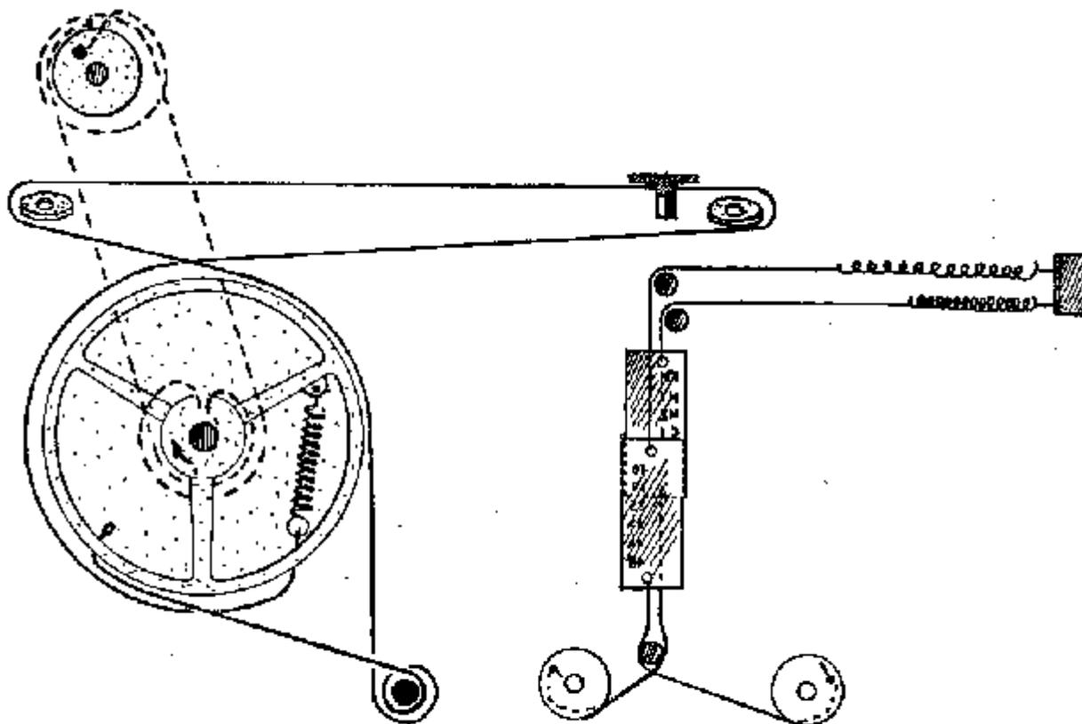
*Meccanica della scala parlante del ricevitore RADIO AL-
