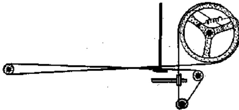
*Meccanica della scala parlante dei ricevitori a valvole SIEMENS modd. SM522 - 524. Il comando di sintonia si compone di due distinti sistemi: quello che comanda la variazione di permeabilità e quello che comanda l'indice della scala.*
