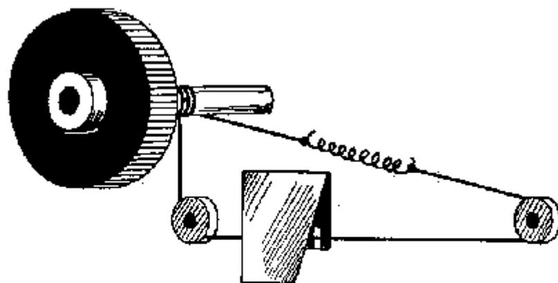
Montaggio della funicella dei ricevitori a valvole SIEMENS modd. 7058 - 7158. In alto è rappresentato lo schema relativo al comando di controllo dei toni alti e bassi. La sua lunghezza è di 26 cm. Il disegno in basso rappresenta lo schema di montaggio della funicella del comando della selettività variabile; la sua lunghezza è di 85 cm.
