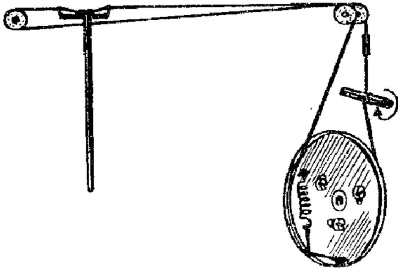
*Montaggio della funicella per il funzionamento della scala parlante del ricevitore PHONOLA mod. 597.*
