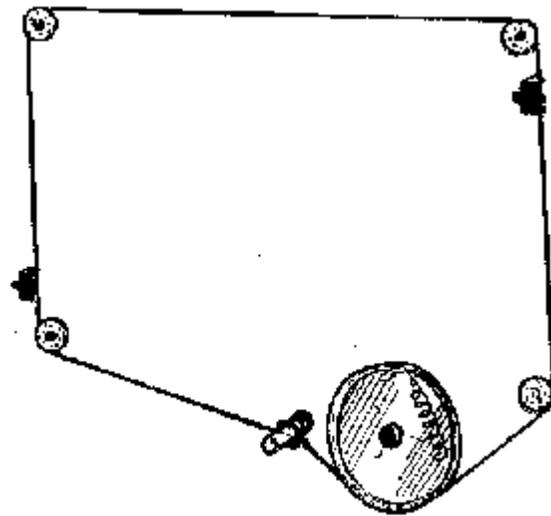
*Meccanica della scala parlante del ricevitore a valvole PHONOLA mod. 5535. La lunghezza della funicella di seta è di 900 mm; alle due estremità devono essere eseguiti due nodi ad usola, in modo che la lunghezza netta della funicella risulti di 840 mm.*
