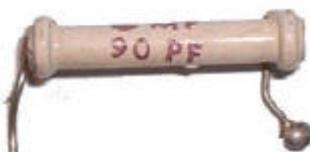
Condensatore ceramico. Si trova **esclusivamente** su apparecchi recenti, nello stadio del convertitore della modulazione di frequenza. La loro verifica può avvenire unicamente se in possesso di un capacimetro. Si guastano difficilmente anche se mi è capitato di trovarne qualcuno completamente "aperto" quindi isolato. Più facilmente sono causa della "deriva termica" nello stadio a modulazione di frequenza (FM), responsabile di continui "ritocchi" necessari alla manopola della sintonia.
