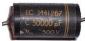
Tipici condensatori che si trovano all'interno degli apparecchi a valvole. Sono tipi di condensatori a carta o impregnati a cera che generalmente **creano grossi problemi**, circa il 70% dei guasti riguarda solo condensatori difettosi.
