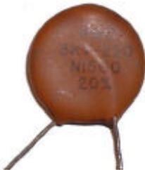
Condensatore a disco. Si trova quasi esclusivamente su apparecchi recenti nello stadio del convertitore della modulazione di frequenza. Non si guastano praticamente mai. La loro verifica può avvenire unicamente se in possesso di un capacimetro. Quello raffigurato qui accanto è un tipo ad alto isolamento (3Kv) normalmente impiegato nei televisori, negli apparecchi radio sono identici ma con tensioni di lavoro di qualche centinaio di volts.
