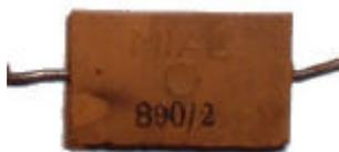
Condensatore a mica. Si trovano unicamente anche questi nello stadio di alta frequenza (GRUPPO AF) delle onde lunghe, medie e corte. Questo tipo qui difficilmente si guasta.
